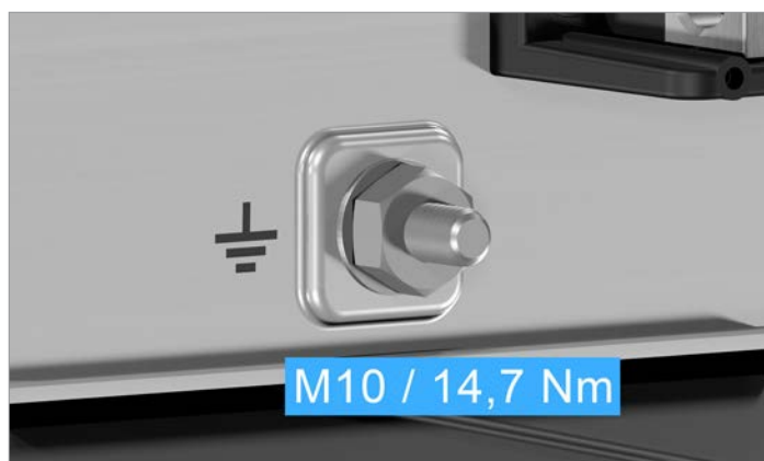
Fig. 5.16: PE connection
