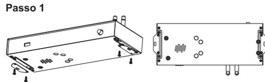
Fixe os suportes que acompanham o produto nos furos localizados na parte inferior do produto; Os parafusos que prendem o suporte no amplificador já estão parafusados, você deve retirá-los para colocar o suporte e parafusar novamente, conforme imagem.
