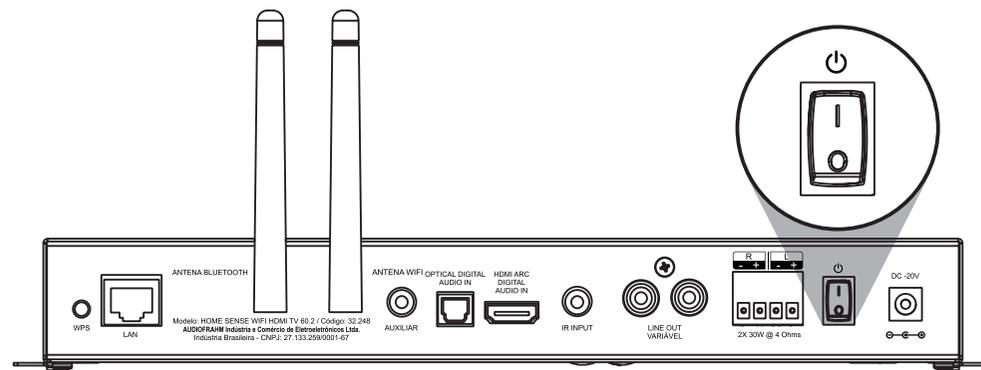
A chave atrás do produto deve estar sempre ligada, o amplificador deve ser colocado em stand-by através do controle remoto, pelo encoder frontal ou via automação. Isso permite que ele esteja em modo de espera para receber qualquer comando de ativação posterior.
