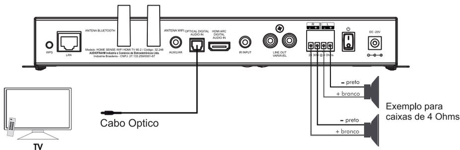
Instalação de 4 Caixas, conexão com a TV (via HDMI)
