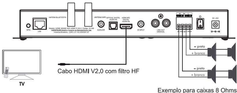
Instalação de 4 caixas + subwoofer ativo, conexão com a TV (Via HDMI)
