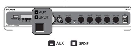
**IMPORTANTE** - Ao utilizar a entrada AUXILIAR, colocar no modo LINE e optar pela entrada através da chave traseira.
